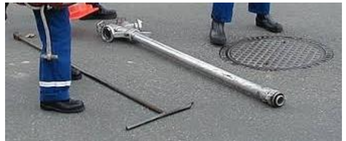
In einigen Orten wurde der Württembergische Schachthyrant verbaut. Er ist rund. Für ihn haben wir ein spezielles „langes“ Standrohr.
